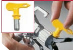
Zur optimalen Anpassung an das jeweilige Objekt bieten die TradeTip2 Düsen ein breites Einsatzspektrum und sind in unterschiedlichen Typen und Größen erhältlich: von 0,007" bis 0,067" und mit Spritzwinkeln von 10° bis 120°. (Siehe aktueller Kompass und Düsenfibel)
