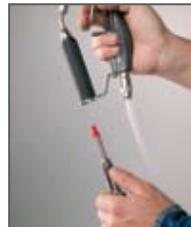
**Ohne Werkzeug** kann das Filtergehäuse zum Reinigen oder Austauschen des Filters geöffnet werden.
