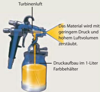
Bei der Niederdruckluft-Technik wird das Lackmaterial mit Hilfe großer Luftmengen, die im Vergleich zum Hochdruckluftspritzen unter niedrigem Druck (bis 0,7 bar) stehen, zerstäubt. Die vermehrt eingesetzten Wasserlacke und Lacke mit hohem Festkörperanteil werden dank der 5-stufigen Turbine kraftvoll verarbeitet.
