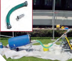
Mit den HeavyCoat-Kolbenpumpen kann Material direkt aus dem 120 l Fass oder aus Großgebinden wie z.B. Containern verarbeitet werden.
