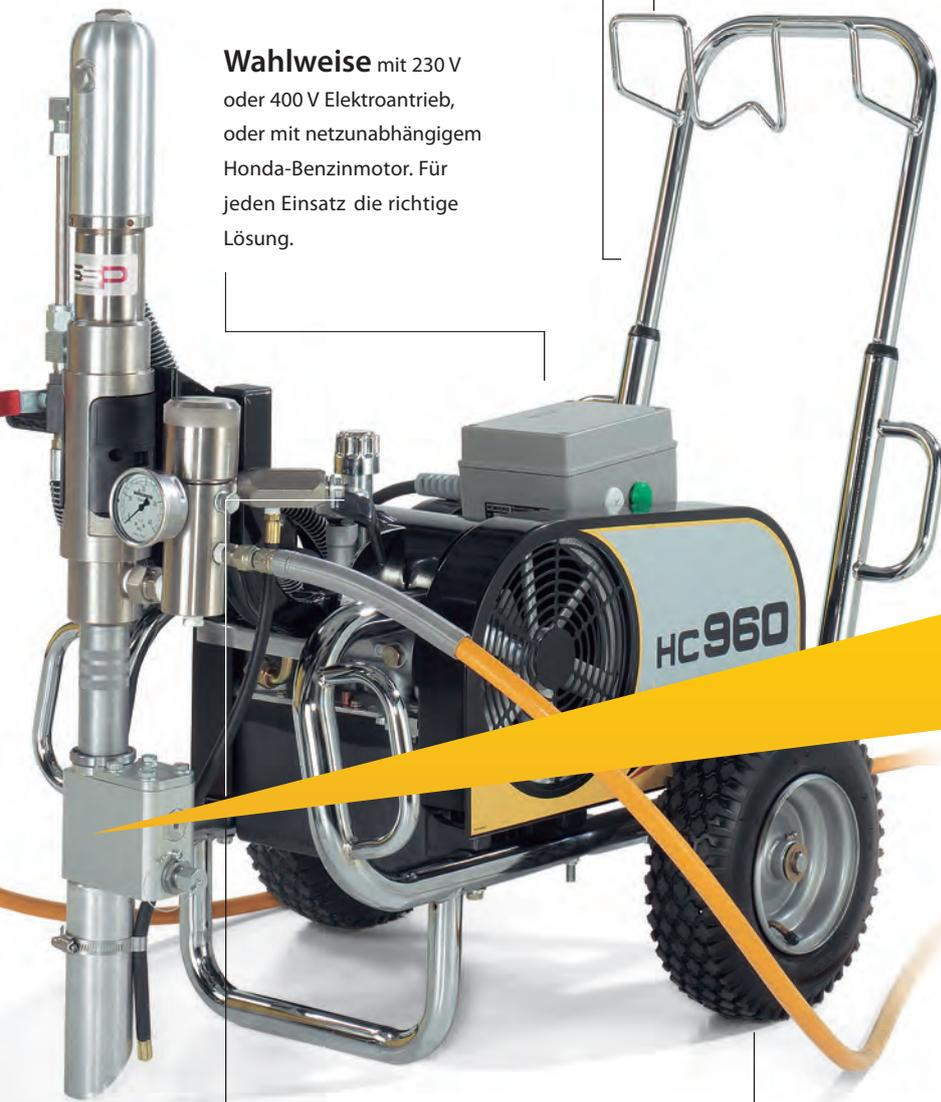
Mit **nur einem Handgriff** lässt sich das Gerät sicher druckentlasten und schnell reinigen.
