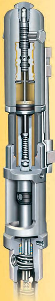
Die Materialpumpe der HeavyCoat-Geräte wird indirekt durch Hydraulik angetrieben. Das hat den Vorteil, dass der Kolben einen deutlich längeren und langsameren Hub ausführt, als bei direkt angetriebenen elektrischen Pumpen. Die hohe Ansaugleistung verbessert die Verarbeitung von **hochviskosen Materialien** aller Art.
